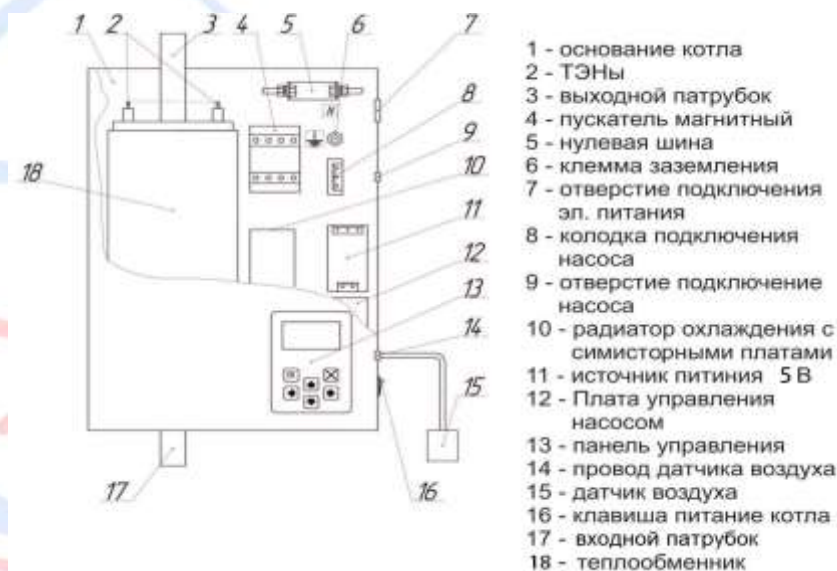
Рисунок 1. Устройство отопителя РЭКО серии П
