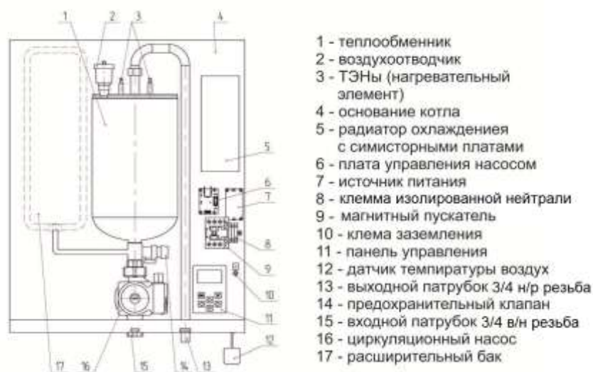
Рисунок 2. Устройство отопителя РЭКО серии ПМ
