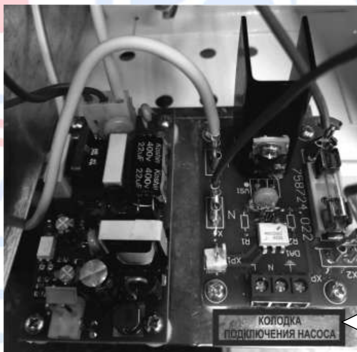
Рисунок 5. Подключение циркуляционного насоса к отопителю
